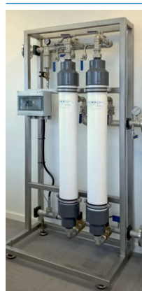
Et blik inde fra containeren, hvor det færdige ballastvandsrensningsanlæg er installeret og klar til at blive sat i drift. Foto: Fayard
